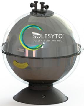
**SOLESYTO® GB22-80BP-E** es un calentador híbrido solar y eléctrico de baja presión que recibe el agua fría por gravedad desde un tinaco instalado sobre una base de al menos 80 cm de altura y que utiliza la energía solar aprovechando la radiación directa, difusa y reflejada para precalentar el agua de su interior gracias a su forma esférica y a las propiedades de los materiales con los que está fabricado.
