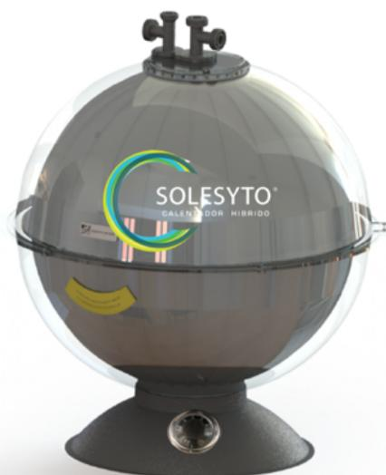
**SOLESYTO® GB23-80BP/MP-E:** es un precalentador solar de baja presión que recibe el agua fría por gravedad desde un tinaco instalado sobre una base de al menos 80 cm de altura que utiliza la energía solar aprovechando la radiación directa, difusa y reflejada para precalentar el agua de su interior gracias a su forma esférica y a las propiedades de los materiales con los que está fabricado.
